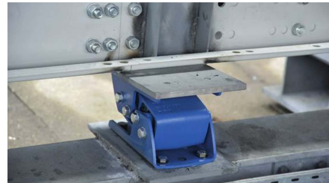
Unidad de aire acondicionado diseñada con ROSTA ESL ®
