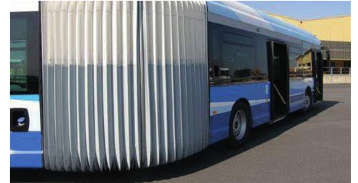
Fuelles de autobús diseñados con ROSTA DR ®.
